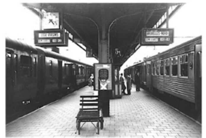
Indicatore di binario con tipo : di treno, destinazione e orario di partenza. Stazione belga anni 1956/57
